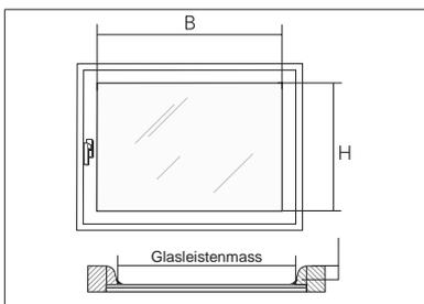
Fensterrahmen mit Dichtung 3 mm oder kleiner
