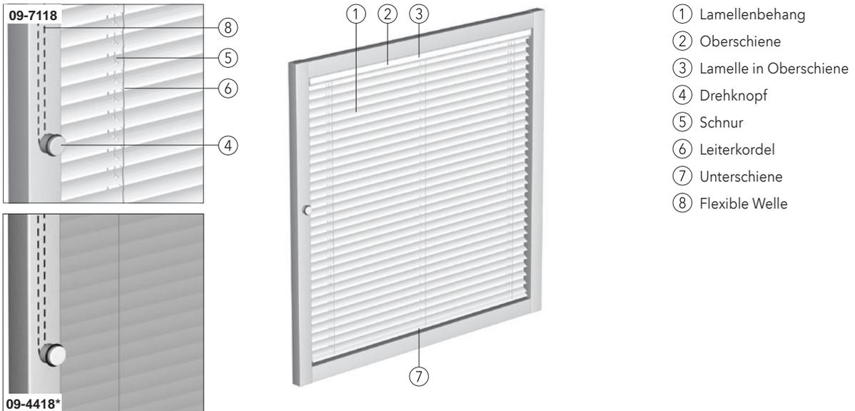
**Modell 09-7118** mit 25 mm Lamellen, Drehknopfbedienung
